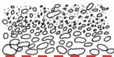
Figure 19 - Filtre naturel développé dans un sol à granulométrie continue
